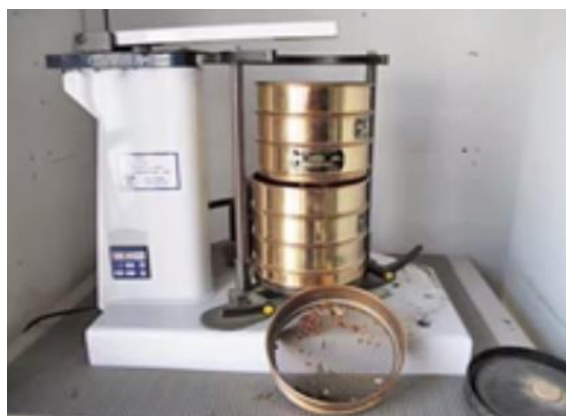
شکل ۹. دستگاه ارزیابی امتیاز فرآیند شدن دانه (در سیلاژ ذرت)
